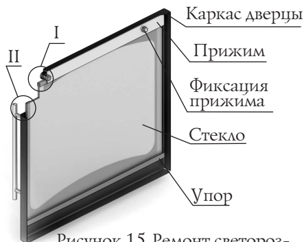
Рисунок 15. Ремонт светопрозрачного экрана дверцы модели «Витра»
