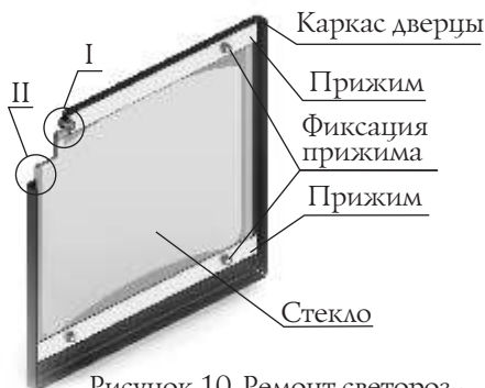
Рисунок 10. Ремонт светопрозрачного экрана дверцы.
