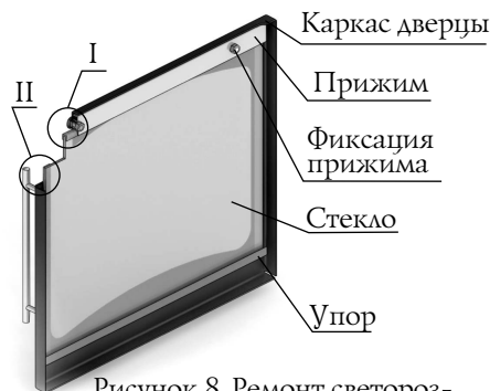
Рисунок 8. Ремонт светорозрачного экрана дверцы модели «Витра»
