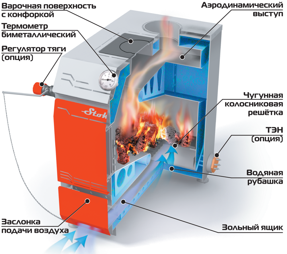
Рисунок - 16. Конструкция аппарата отопительного Stoker Aqua 18-П/Э. Конструкция внутреннего контура аналогична для аппаратов отопительных Stoker Aqua 14-Э, 16-П/Э, 18-Э
