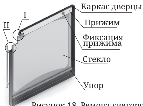
Рисунок 18. Ремонт светорозрачного экрана дверцы модификации «Витра»
